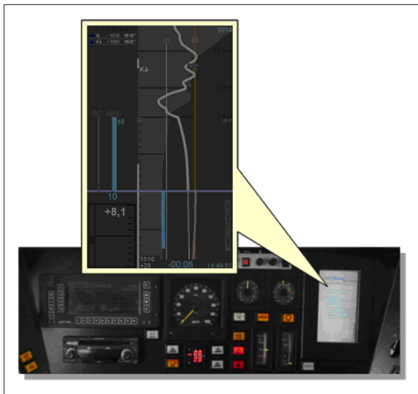
Figur 15: CATO:s förarränsnitt och installation i förarbrord.
